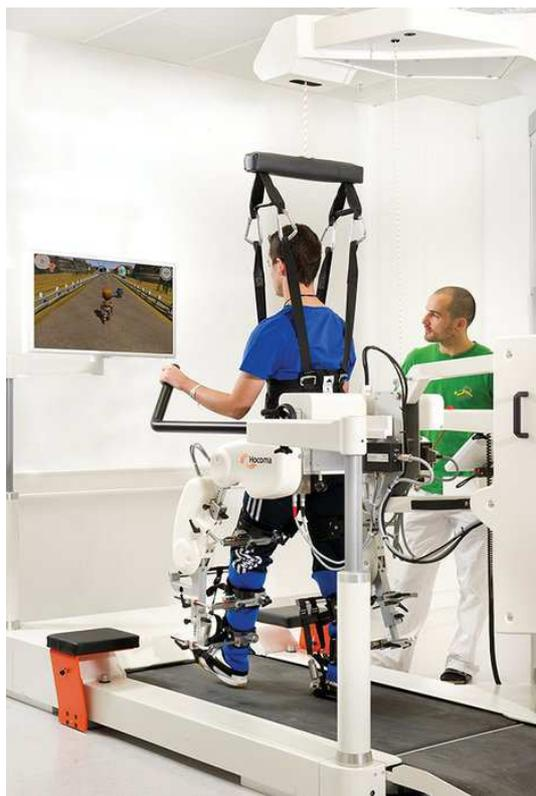
Abbildung 16: Rehabilitationsrobotik: Robotische Gangtherapie in einem „Lokomat“.
