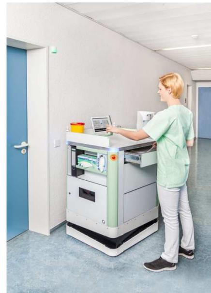
Abbildung 10: Intelligenter Pflegewagen auf Basis des Serviceroboters Care-O-bot 4, entwickelt von Fraunhofer IPA.
